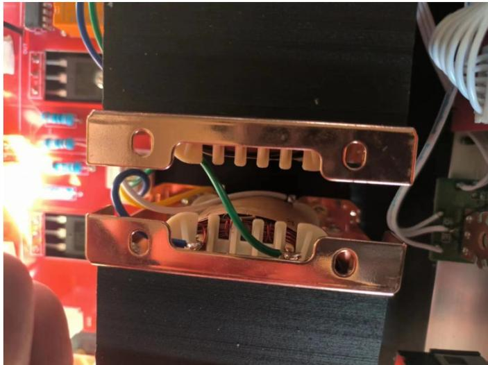
输入切换这部分本着发烧的原则，依旧选用继电器切换，为了照顾喜欢用平衡输入的用户，特别增加一组平衡输入，平衡芯片由专用的 IN137UA 完成，输入切换的供电部分由独立的绕组电源完成。
